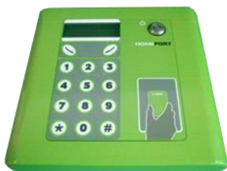
Konzola obsahuje RFID čítačku kariet, Klávesnica, LCD display.
