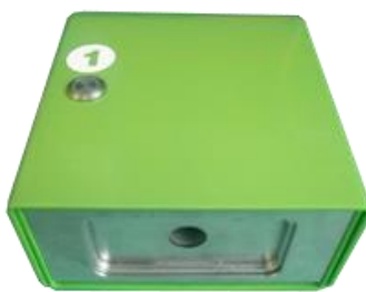
Dokovací zámok číta čipy umiestnené na hrotoch bicyklov.
